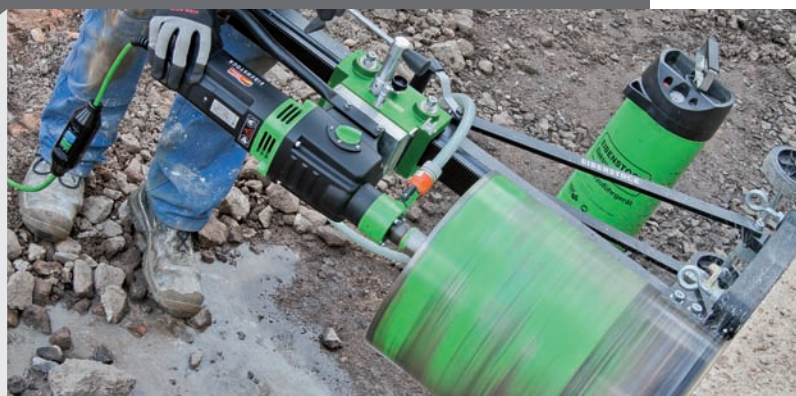
BST 352 V: auf vier Spezialkugeln gelagerter Schlitten
